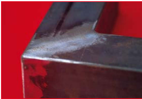
Metallteil vor dem Verzinken. Die Schweißnähte sind plan geschliffen.
