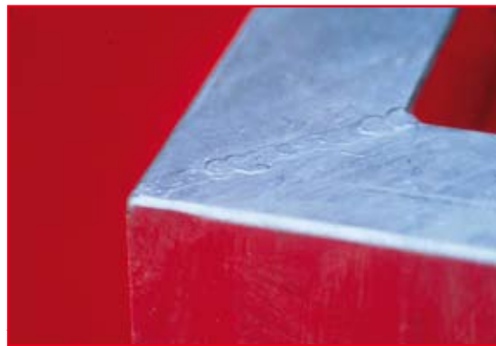
Die Schweißnähte sind aufgewachsen.
